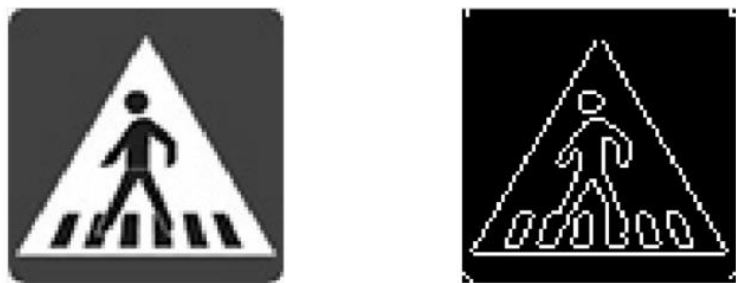
Fig3. Sobel edge detection.
